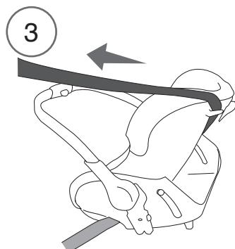
**ATENCIÓN:** Ajuste el tendido del cinturón cada vez que cambie la posición del respaldo.
